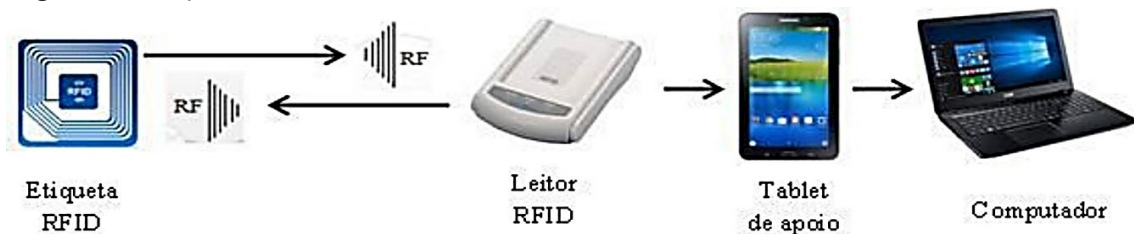
Figura 1: Componentes básicos de um sistema RFID.
