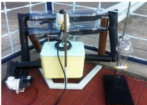
Figura 1 – Protótipo do coletor solar sustentável
